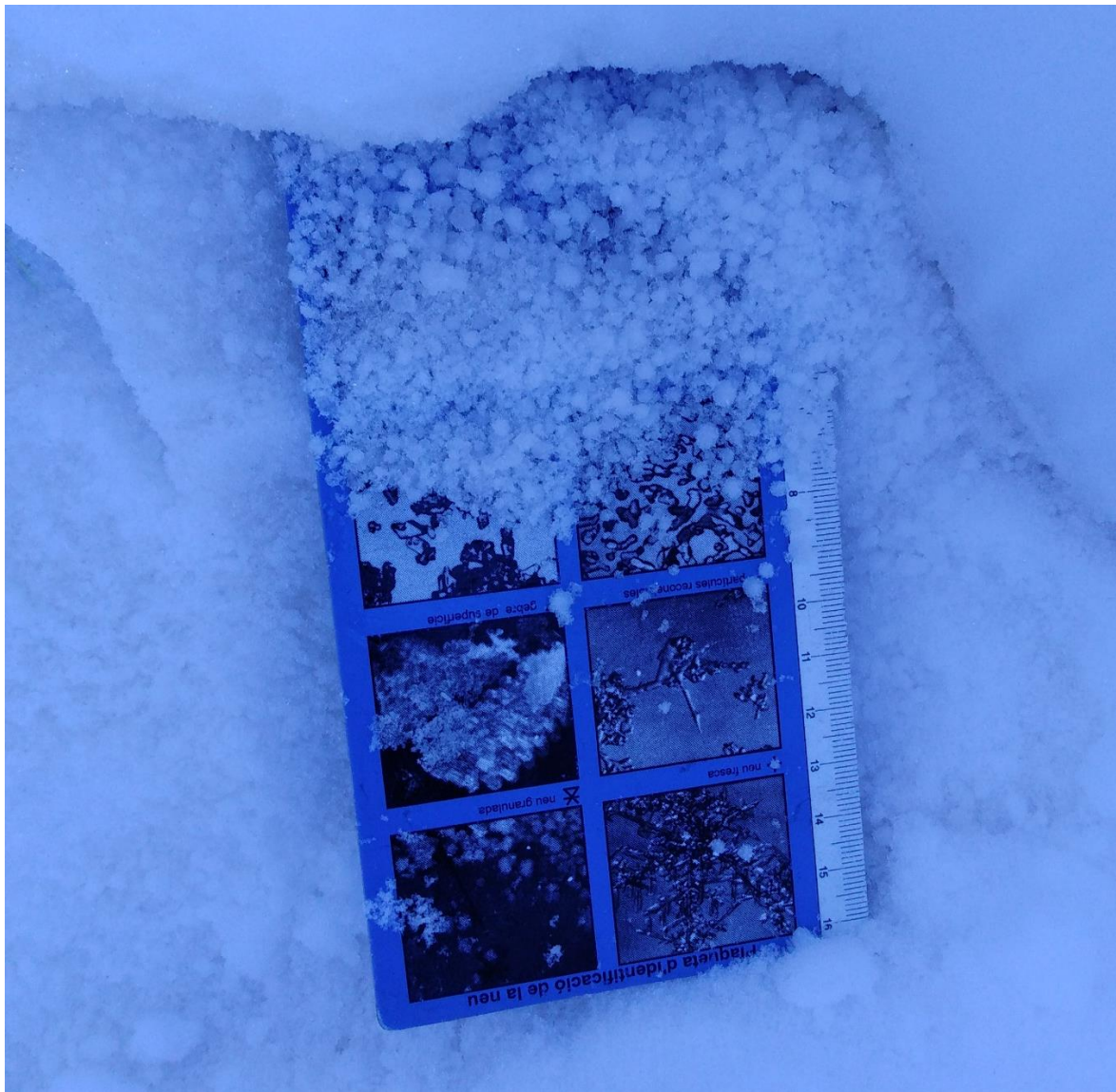
Nieve granulada (PPgr) observada en las capas inferiores del manto en el Canal del Ticó (Vessant Nord del Cadí-Moixeró) el 19 de febrero. Este tipo de nieve actúa como capa débil persistente y, de hecho, los tests realizados han dado un resultado positivo, con propagaciones de las fracturas.
